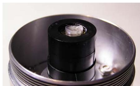
図 2. PhE-PbBr<sub>4</sub> 結晶を PMT に装着したところ。
