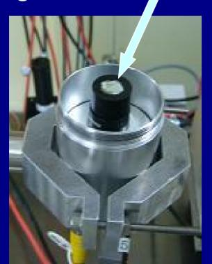
試料: Ni-61濃縮(95%) 金属箔、 5x5x0.38t mm 非弾性散乱配置 (AL3mmt の上に試料をセット)
