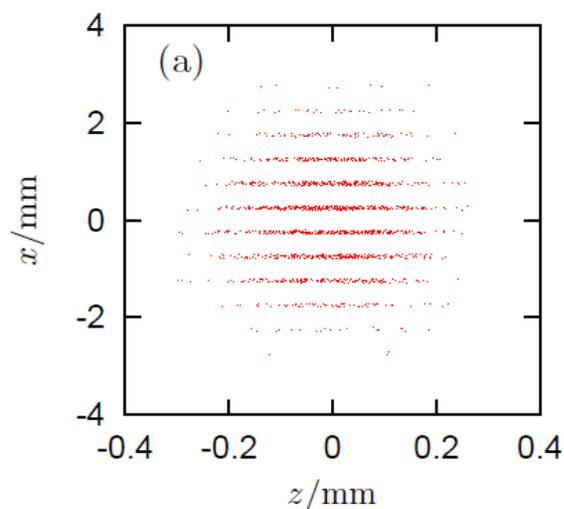
図 2: 位相空間回転への入力として生成した短冊状のビーム分布。縦軸および横軸は各々  $x$  位置、 $z$  位置を示す。
