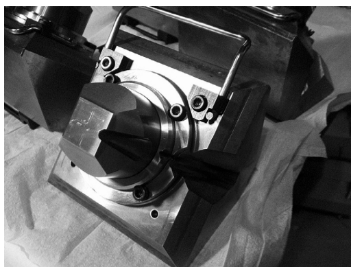
図6 彫り込み付きサイドアンビル
