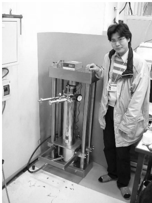
図 6 試作した小型キュービックアンビル装置
