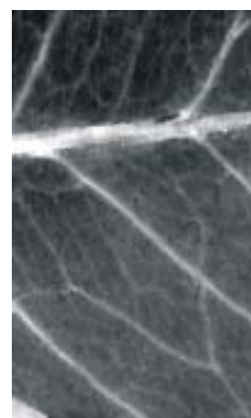
図4 . BBB 干渉計により撮影されたクローバーの葉の位相マップ。
