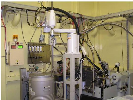
図1 . AR-NW12A に設置された結晶交換ロボット
