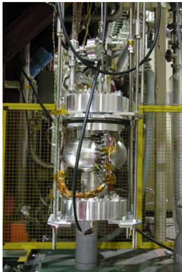
図 2 (左) セットアップされて縦測定を待つ単セル空洞
