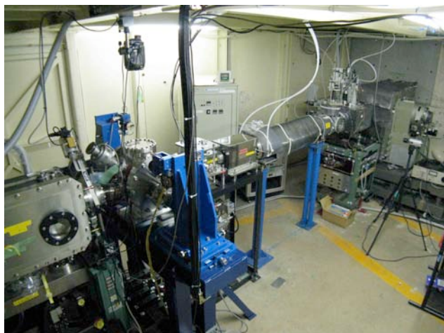
[写真1] メインハッチ内ビームライン 右上上流から分光器、4D スリット、 BS、高分解能分光器、縦集光ミラー
