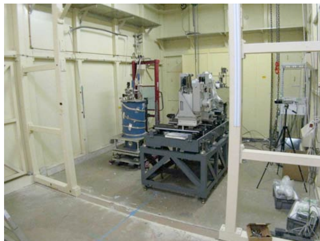
[写真2] 実験ハッチ内部 右上上流から横集光ミラー、 メスバウアー分光実験装置
