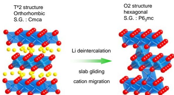
Fig. 1 構造変化のモデル図
