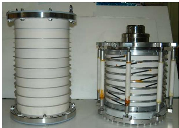
図2: 500 kV 用分割型セラミック管 (左) と JAEA-FEL の 250 kV セラミック管 (右)
