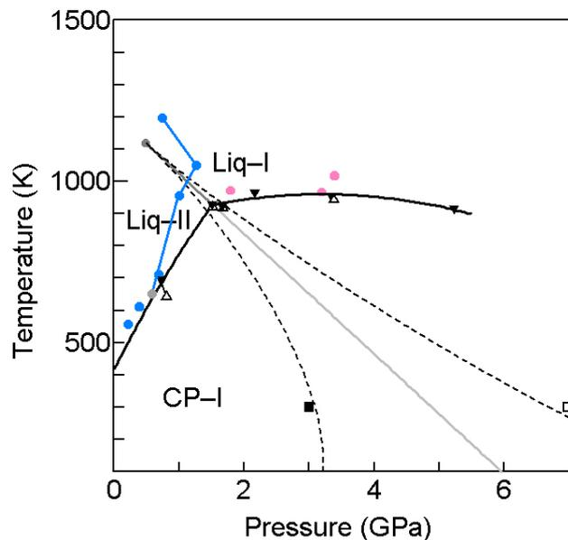
さて, 仮定 i)については何ら物理的根拠を伴わない. そこで, 図中の水色線に沿って, 低圧領域での液体構造のその場観察を行ったところ, この領域では Liq-II が観測された. 臨界点の存在が危ぶまれるが, 四面体型のオープンな局所構造を強く好む場合には臨界点を伴う相転移が実現するため[3], ヨウ化錫分子からなる Liq-II の相転移についても臨界点の存在を有するシナリオが依然として期待される. そこで, 臨界点圧力を 1.3 GPa に設定し直し, 相図の再考を行ったところ, 臨界点温度 970 K, 両液相エントロピー差  $20 \text{ J mol}^{-1} \text{ K}^{-1}$  が得られた.
