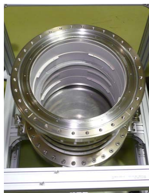
図:チタン製電子銃容器(左)、セラミック管(中央)、ガス放出速度測定結果(右)
