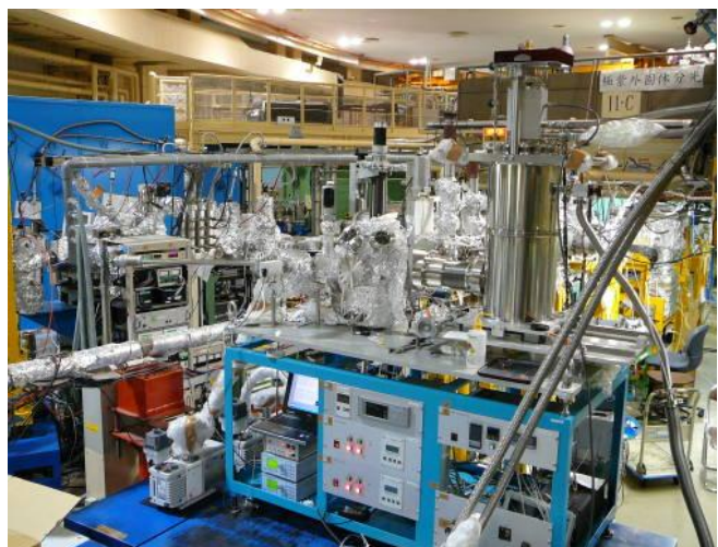
図 1. 超伝導検出器を搭載した軽元素用蛍光収量 XAFS 分光装置。
