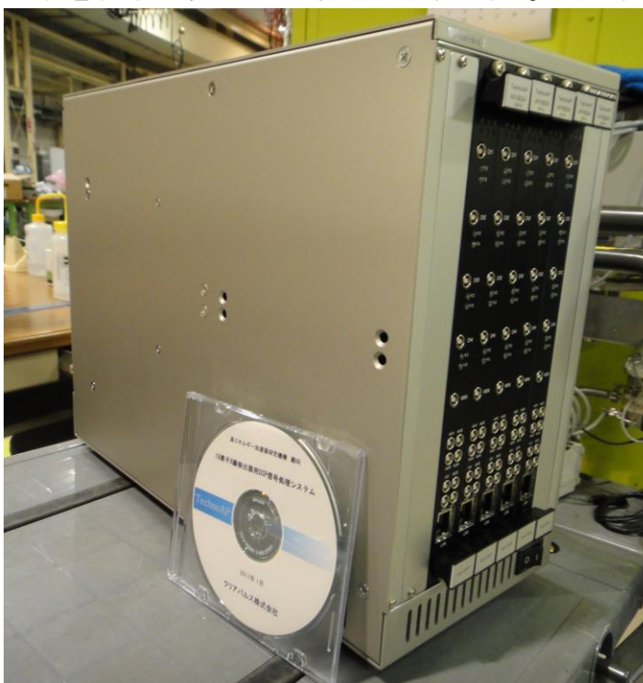
図. テクノ AP 社製 20ch 高速 DSP 「APV-8004」
