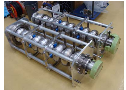
(左図)入射部空洞用入力カップラー (右図)主加速部用超伝導空洞
