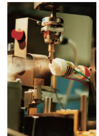
ヨナット博士が開発した低温窒素ガス吹き付け装置。
