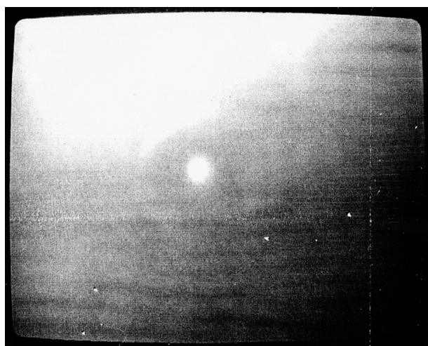
標的前のスクリーンで観測したビームスポット。ビームエネルギーは約40 MeV。パルス幅15 ns、パルス当たりの電荷約10 nC、繰返し5 Hzで調整中。
