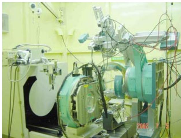
写真1 イメージングプレート使用時のハッチ内風景。ビーム上流側に Huber 社製 7 軸回折計が設置されている。
