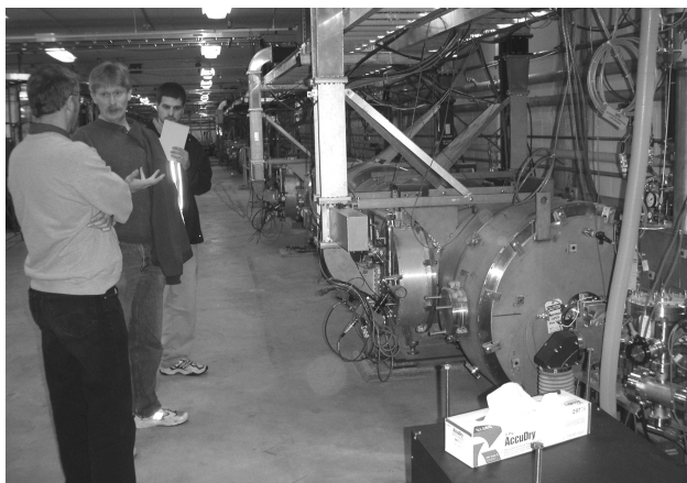
図5 赤外線 FEL 施設 (IR Demo) の内部。右側に見えるのが超伝導加速管を納めたクライオモジュール。
