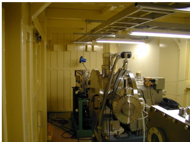
図5. 光学ハッチ内に設置されたミラー調整装置と二結晶分光器
