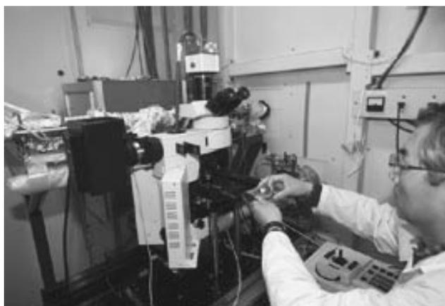
放射光X線マイクロビーム細胞照射装置
