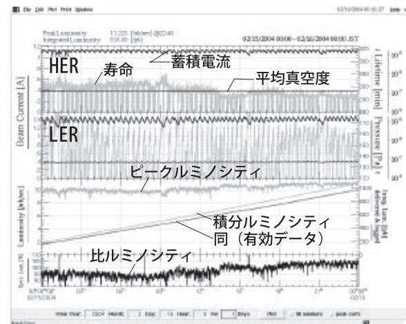
図) 連続入射モード時のKEKB 加速器運転表示グラフ。上段より、HER, LER, ルミノシティの状態を示す。横軸は時刻で、この例は2月15日午前0時から2月16日午前0時までの24時間を示す。上段及び中段のグラフは、各々、上から各リングの蓄積電流、ビーム寿命、リング全周の平均真空度を示す。下段及び最下段の4つのグラフは上からピークルミノシティ、積分ルミノシティ、実験に使われた積分ルミノシティ、比ピーケルミノシティを示す。
