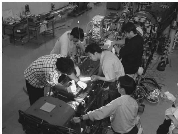
図2 セプタム電磁石更新作業
