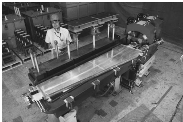
図3 偏向電磁石部真空ダクトの試作、組立て
