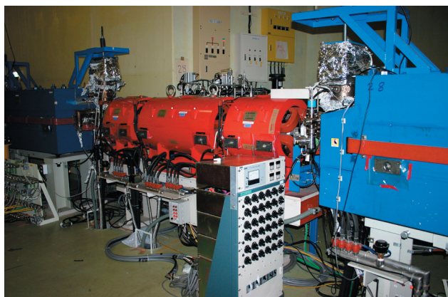
写真1 改造前のB28-B01間。細くて長い四極電磁石のトリプレットに占有されていた。
