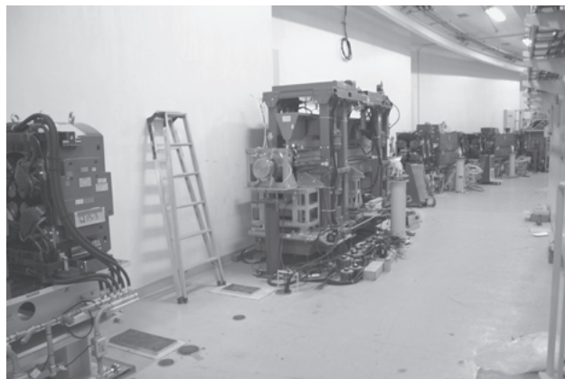
写真4 南長直線部の延長。中心に写っている MPW#16 と左端の新四極電磁石の間に約 2 m のフリースペースが出現。
