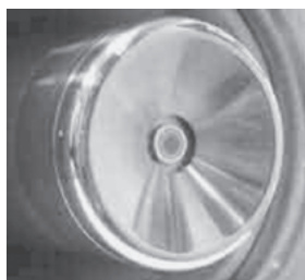
図 カーボンナノチューブ電子銃陰極 = 直径2.6 mm (上), パルス波形 = 半値幅約8ナノ秒 (中), 電流安定度 (下)。
