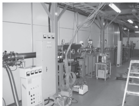
図1 BL-17A ビームライン設置完了。写真真ん中にあるのが、非対称湾曲水平集光ミラーベンダー。
