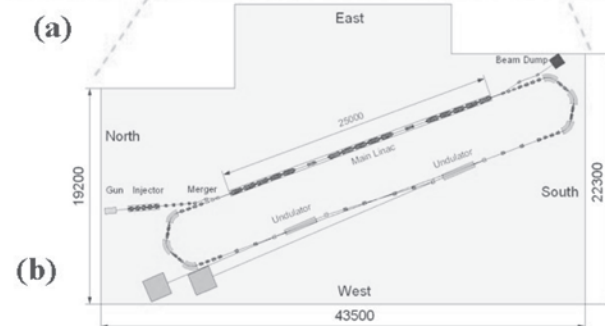
図2 冷中性子棟内に計画している実証機概念図
