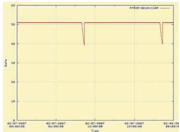
図 9 リング電流の 24 時間の記録。2 回の減衰は PF-AR 入射により Top-up 入射を止めたため。
