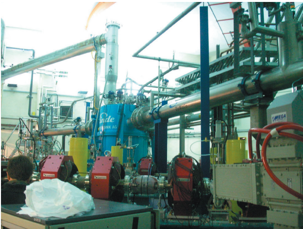
図2 ERLプロトタイプの内部。ビーム周回部の向こうに極低温設備の一部が見える。ERLでは、ビーム輸送路に比べて極低温設備が大規模になる。
