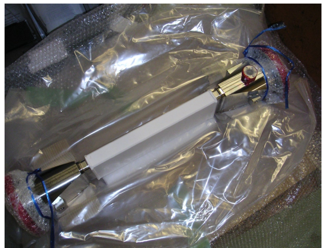
4極電磁石の中に入っているセラミックダクト。
