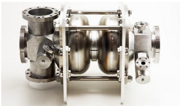
写真3 前段加速の2連の試作空洞
