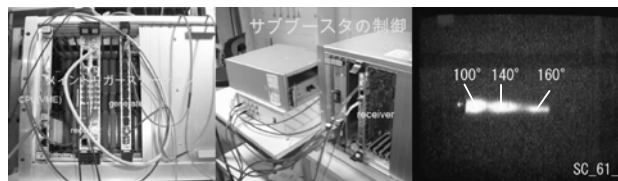
図2 (左) 主制御室近くのメイントリガーステーションに設置された Event Generator。(中) 第3セクターサブブースター「SB-3」電源付近に設置された Event Receiver と位相設定/モニター用 DAC/ADC。(右) 入射器終端に設置されているビーム偏向電磁石下流のスクリーンで観察したビームスポット。SB-3の位相を3種類(100°, 140°, 160°)変えることにより、第3セクター8台の大電力RF源の位相を同時に変えると、エネルギーの違いによりビームスポットが写真のようにずれて観測される(右方が低エネルギー側)。位相は20ms毎に変更し、「100-140-160-100-140」度のパターンを繰り返した(位相160度のビームパルスは他の1/2の頻度なので暗く見える)。
