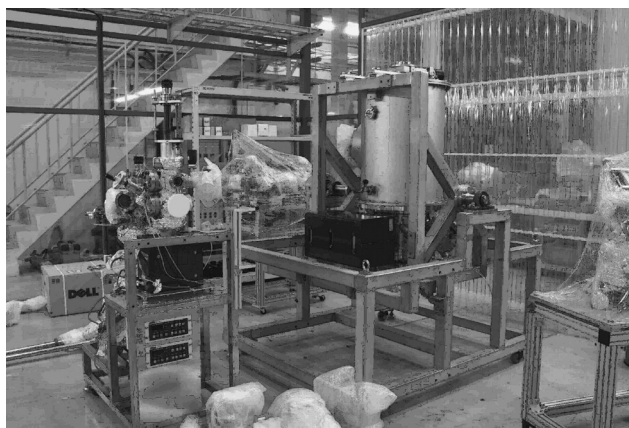
図4 200 kV/DC 電子銃の PF-AR 南棟への移設作業（上）と移設が完了した 200 kV/DC 電子銃（下）。
