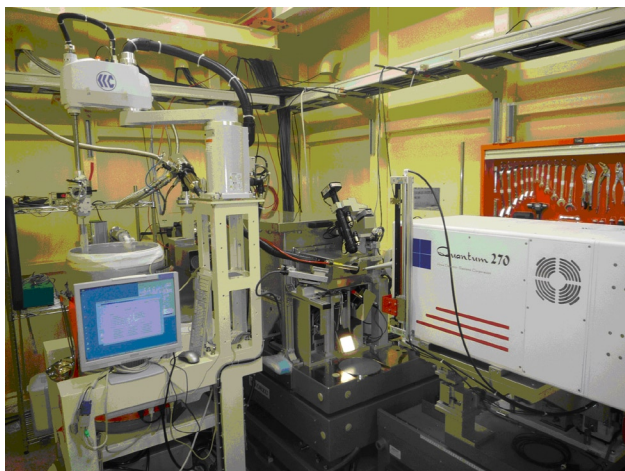
AR-NE3A の実験装置の様子。左から PAM, 高精度回折計, CCD 検出器 (Quantum270)
