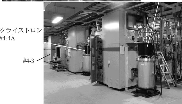
図2 #3-1加速ユニット撤去によるエネルギー補充のため、#4-4Bに新設されたCバンド加速ユニット。加速管#4-4B-1(写真左上)とRF電源#4-4B(写真右下)。今回は加速管1本のみ設置。来年夏残りの3本(#4-4B-2～4)を設置する予定。RF源#4-4Aと#4-4Bは、小型高電圧直流電源を用いたコンパクトなRF源で、左側(上流)に見える従来型RF源(#4-3)の半分の大きさである。
