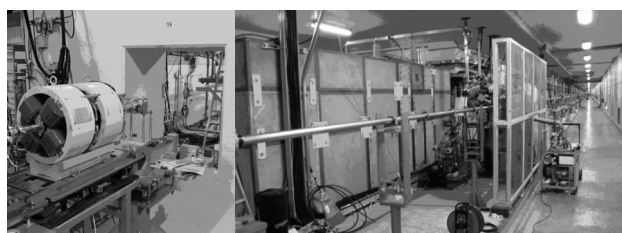
図1 #C-8上流(旧PF用入射部, 写真左)から#3-1(写真右)に移設された電子源。
