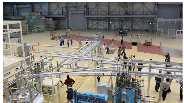
図1 東カウンターホールのギャラリーを埋め尽くした見学者(上)と実験ホールの様子(下)。下の写真の手前の設備は超伝導空洞を冷却するためのヘリウム冷凍設備。
