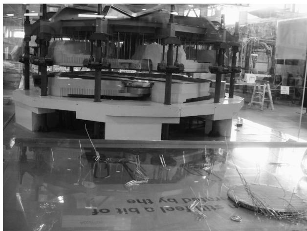
図2 TRIUMFの世界最大サイクロトロン模型。立ったクリップとコインで磁場の強さが分かる。
