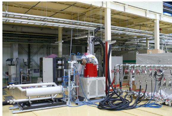
図3 東カウンターホールに設置された300kWクライストロン
