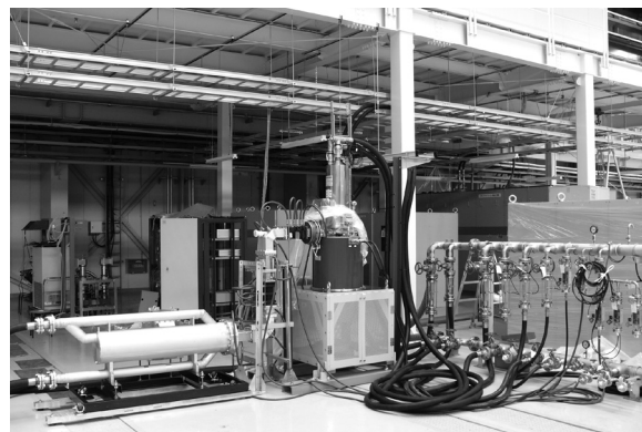
図 3 東カウンターホールに設置された 300 kW クライストロン
