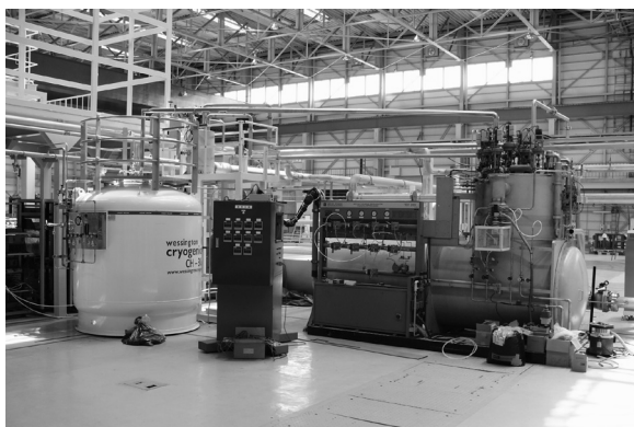
図 2 物質・材料研究機構から譲り受けたヘリウム冷凍機とトランスファータンク
