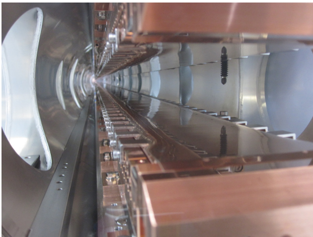
図6 XFEL用長尺アンジュレーターの外観(上)と磁極列(下)
