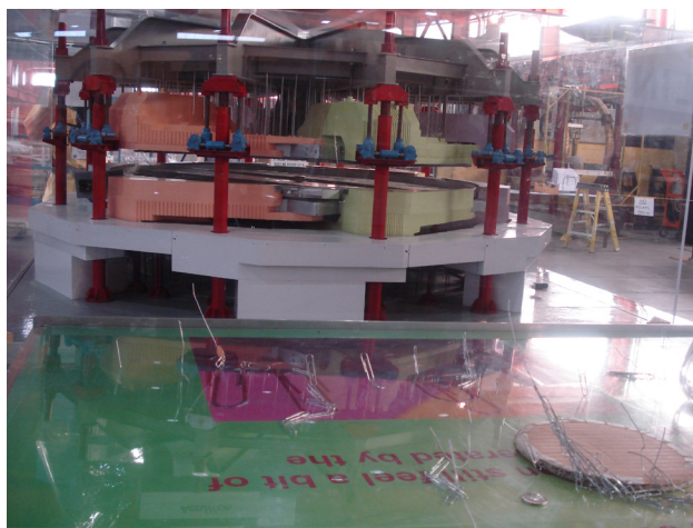
図2 TRIUMFの世界最大サイクロトロン。立ったクリップとコインで磁場の強さが分かる。
