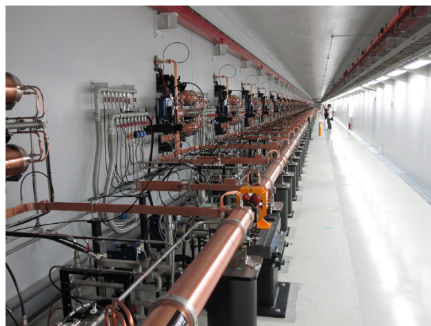
図5 Cバンドのチョーク型加速管が並んだXFEL加速部
