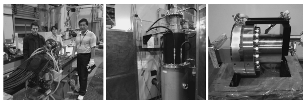
図1 (左) 陽電子集束用フラックスコンセントレータの磁場測定を準備する(向かって左から)BINPのPavel Martyshkinさん、入射器の横山さん、招聘研究員のIHEPのPei Guoxiさん。(中) 試験運転直前のLバンドクライストロン。(右) Lバンド用ダミーロード。
