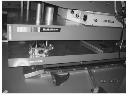
写真3 位置調整用レールから脱線した回折計
