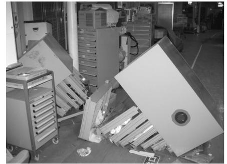
写真7 引き出しが飛び出し、転倒したツールボックス
