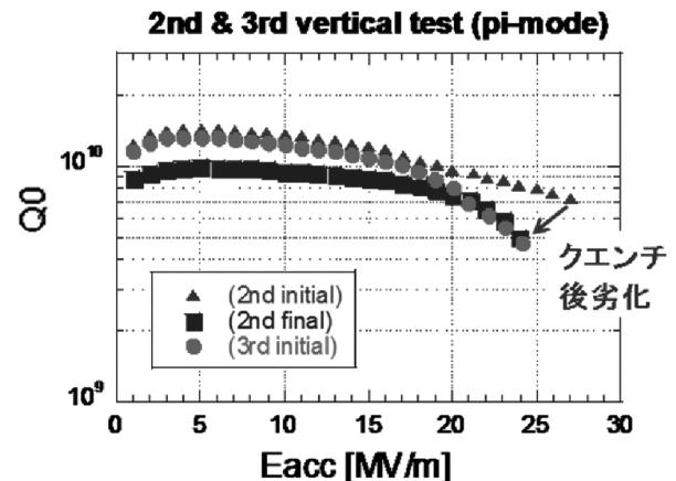
図 3 2 号機縦測定結果（2 回目 & 3 回目）
