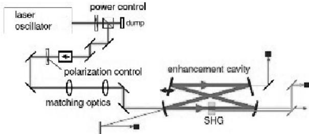
図5 共振器型による基本波の強度増強のスキーム
