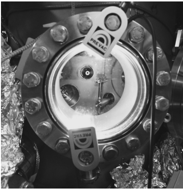
図2 PREVAC社のLEDライト。ビューポートの縁に取り付ける事で、手やビューポートを塞がずにチャンパー内部を明るく照らすことが出来る。
