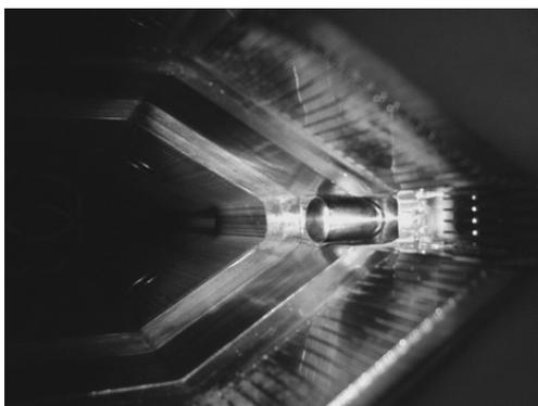
図 2 RF シールド付きゲートバルブ付近の真空チャンバー内部の様子。
