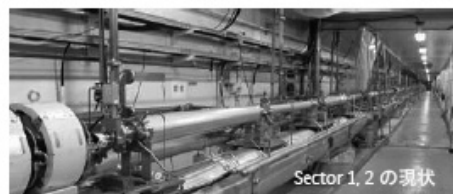
図2 セクターA~セクター2の様子。加速ユニットの真空を立ち上げたが、ビームラインはまだ復元していない。
