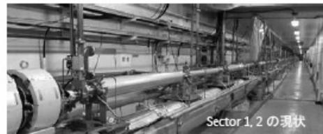
図2 セクターA~セクター2の様子。加速ユニットの真空を立ち上げたが、ビームラインはまだ復元していない。
