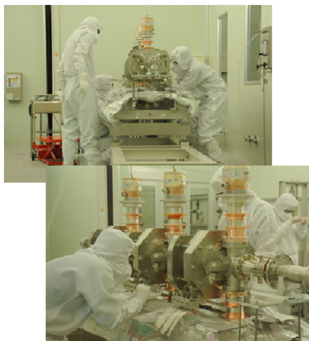
図 3 ERL 開発棟内にあるクリーンルームで始まった、入射部の超伝導空洞組み立て作業の様子。
