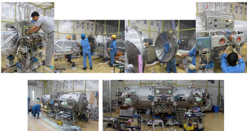
図4 9月には主加速部超伝導空洞の温度センサー、磁気シールド、各種配線の整理を行い、クライオモジュールに組み立て完了。
