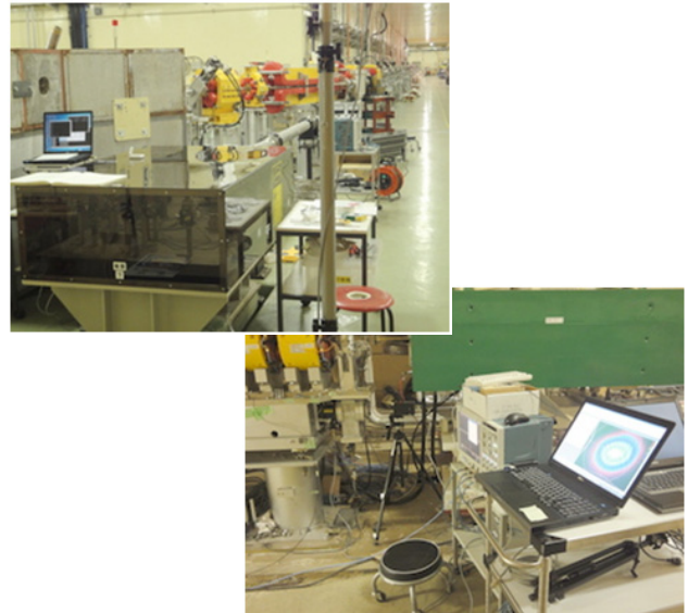
図2 長基線アライメント用レーザ（上）と500 m先の安定度監視測定器。
