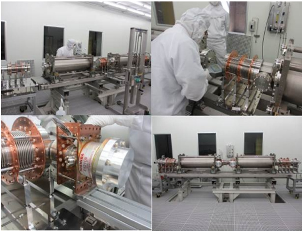
図3 8月始めからクリーンルームで行われた主加速部超伝導空洞の組立作業の様子。
