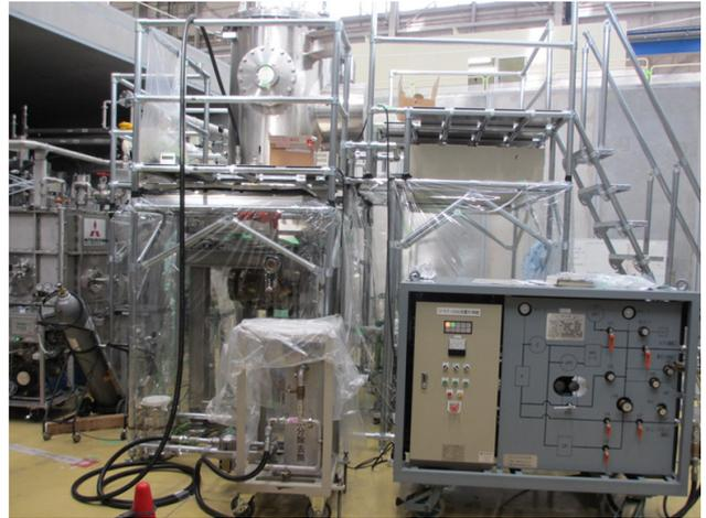
図3 4月の電子ビーム試験に向けて整備が進められている高輝度電子銃。
